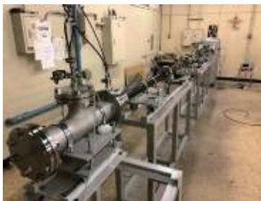
Fig1. 本研究室所有の反射型衝撃風洞
